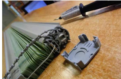
↑ 2. Die Kette lockern bzw. herausnehmen
