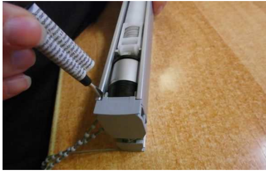
↑ 1. Mit einem kleinen Schraubendreher vorsichtig die Endkappe lösen.
